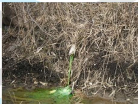
Le **captage indirect en provenance des drains de fondations** constitue souvent un élément important expliquant la présence d'eaux parasites dans les réseaux d'égouts, notamment lorsque la nappe souterraine est élevée suivant la fonte printanière ou suivant des événements comportant de fortes accumulations de pluies. Le drainage des fondations devrait idéalement se faire en surface, à bonne distance du bâtiment.
